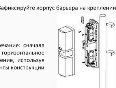
Примечание: сначала отрегулируйте горизонтальное направление, используя крепежные винты конструкции
